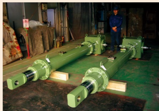
推力490KN 同調シリンダ ストローク:2000mm
