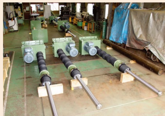
推力196KN ストローク:1500mm 16台
