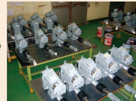
東南アジア向け 推力:9.8KN 速度100mm/sec
