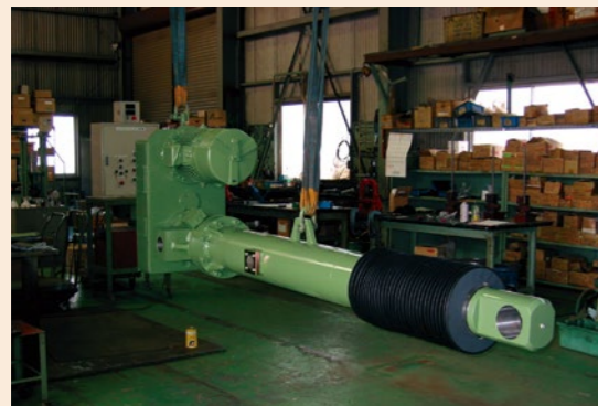
推力314KN 転炉蓋昇降用シリンダ ストローク:850mm
