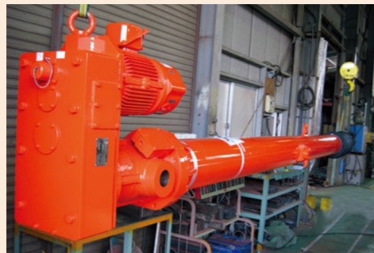
推力58.8KN ストローク:3600mm
