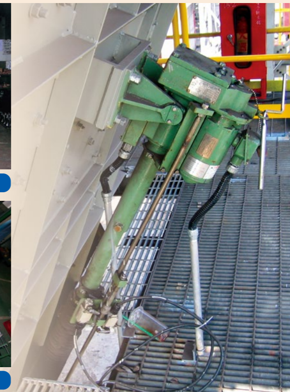
147KNトラベリングナット式ジャッキ
