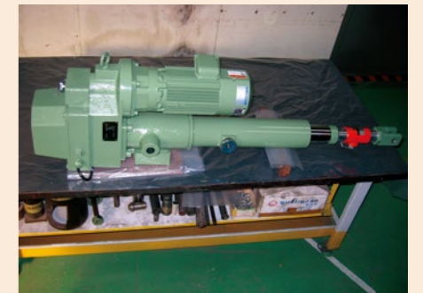
ロードセル付シリンダ 推力:29.4KN
