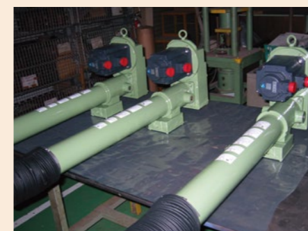
推力:6.9KN サーボシリンダ クリーンルーム仕様
